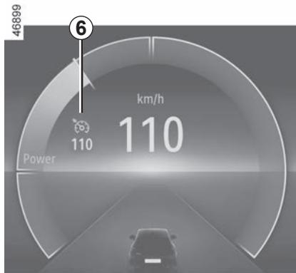
Kontrolno svjetlo **6** nestaje s instrumentne ploče kao potvrda da funkcija više nije uključena.
