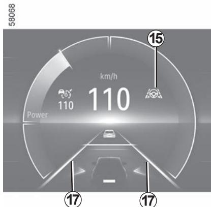
Kontrolno svjetlo **15**
