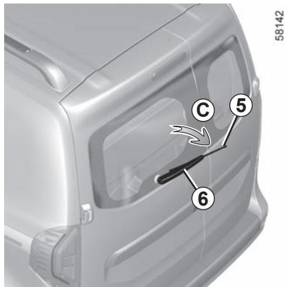
Provjeravajte stanje metlica brisača stakla.
