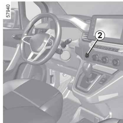
Ako pametni telefon više nije u putničkom prostoru kada želite zaustaviti motor, prikazuje se poruka se na instrumentnoj ploči: pritisnite i držite gumb za pokretanje/zaustavljanje motora više od dvije sekunde **2**.
