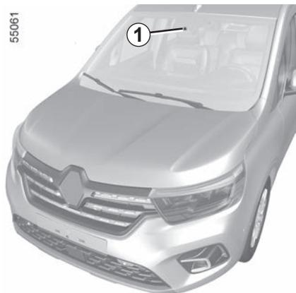
S pomoću podataka s kamere **1** ova funkcija upozorava vozača na prelazak preko linije vozne trake (pune ili isprekidane) bez uključivanja pokazivača smjera.
