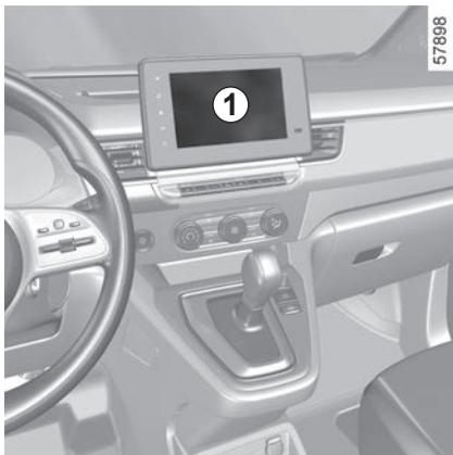
**Dok motor radi** i vozilo je zaustavljeno, s multimedijskog zaslona **1** odaberite izbornik "Postavke", karticu "Vozilo", izbornik "Programiranje el. vozila" **2** i zatim karticu "Klimatizacija" **4**.
