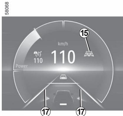
Ako vozač ne intervenira, funkcija pokreće vibriranje kola upravljača da bi ukazala na to da će vozilo ubrzo prijeći liniju te da vozač mora odmah djelovati.
