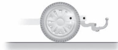
Uređaj za vuču ne smije ometati dijelove rasvjete ili registarsku pločicu kada se ne koristi. Mehanički uređaji za vuču (kugla, kuka i sl.) koje je moguće skinuti bez alata i uvlačivi uređaji moraju se skinuti ili premjestiti kada nisu u upotrebi.
