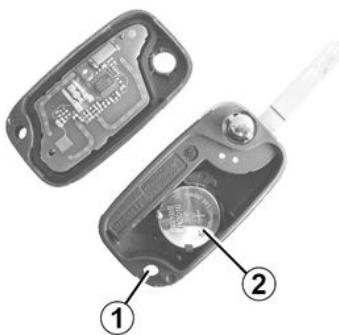
Otvorite kućište kroz prorez **1** s pomoću plosnatog odvijača ili sličnog alata i zamjenite bateriju **2**, uzimajući u obzir vrstu i polarnost prikazanu na stražnjoj strani poklopca.
