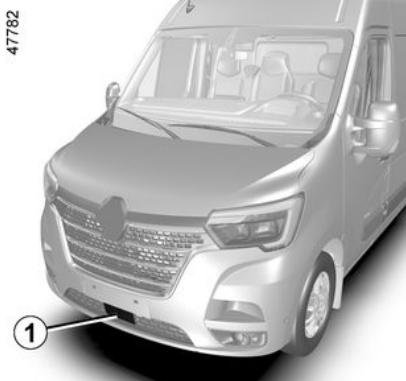
Na temelju podataka s radara 1, sustav izračunava udaljenost u odnosu na vozilo ispred.
