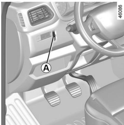
Na vozilima koja su njome opremljena, komanda **A** omogućava podešavanje visine svjetlosnog snopa ovisno o opterećenju.
