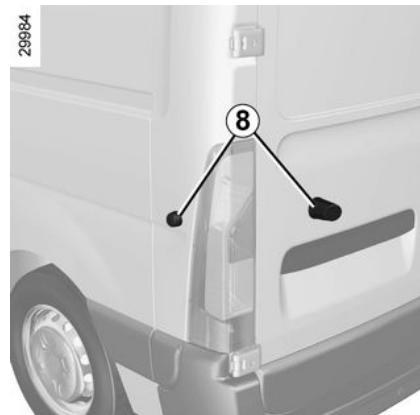
Uklonite šipku 7 iz njenog ležišta 5 kao kod otvaranja za 180°. Otvorite vrata do kraja dok magneti 8 ne dođu u kontakt.
