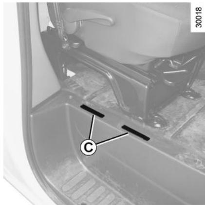
Za pristup modelu vozila i broju serije modela, otkvačite pokrove **C** plosnatim odvijačem ili sličnim alatom.
