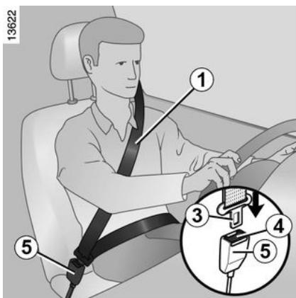
Povlačite pojaz **lagano i jednolično** sve dok jezički kopče **3** ne sjednu u kućište za zabravljinje pojaza **5** (provjerite je li pojaz blokiran povlačenjem kopče **3**).
