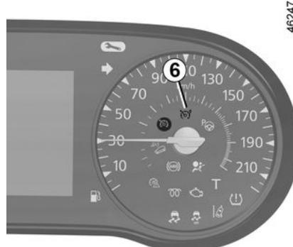
Pritisnite prekidač **5** na strani . Upalit će se narančasto kontrolno svjetlo **6** i prikazat će se poruka „Ograničivač brzine“ na instrumentnoj ploči popraćena crticama kako bi označila da je funkcija ograničivača brzine uključena i u očekivanju pohranjivanja ograničene brzine.
