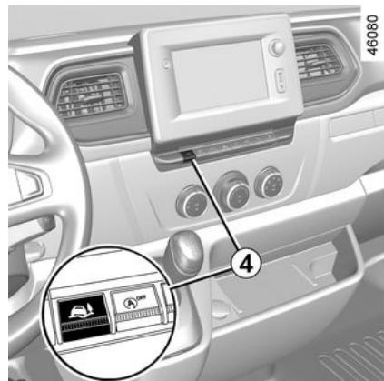
Pritisnite prekidač **4**: na instrumentnoj ploči pojavljuje se poruka „Uključen je način rada za rastresito tlo“.
