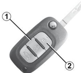
Kada je vozilo njime opremljeno, ono omogućava zaključavanje svih otvarajućih dijelova i sprječava otvaranje vrata pomoći unutarnjih kvaka (u slučaju razbijenog stakla nakon čega slijedi pokušaj otvaranja vrata iz unutrašnjosti).
