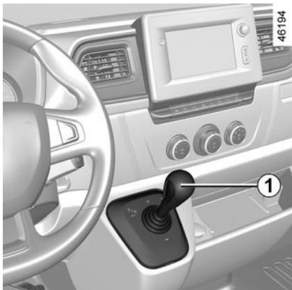
– Omogućava izravno prebacivanje iz prve brzine u brzinu za vožnju unatrag, odabir brzine za vožnju unatrag i praznog hoda te promjenu stupnjeva prijenosa u ručnom načinu rada.
