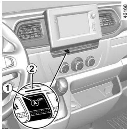
Za isključivanje funkcije pritisnite prekidač **1**. Kontrolno svjetlo **2** se pali.
