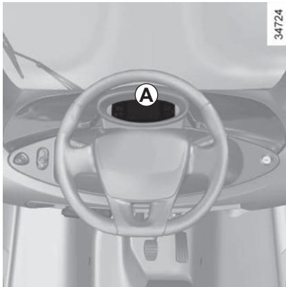
Instrumentna ploča A osvjetljava se pri uključenju kontakta.
