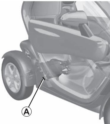
Podaci koji se nalaze na pločici motora ili na naljepnici A moraju biti navedeni u svim vašim pismima ili narudžbama.
