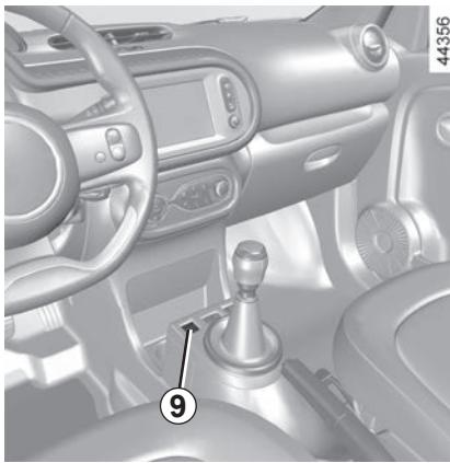
**Vozila opremljena načinom rada ECO (prekidač 9):** kada je uključen, način rada ECO može smanjiti učinkovitost automatskog klima uređaja. ➔ 2.16.
