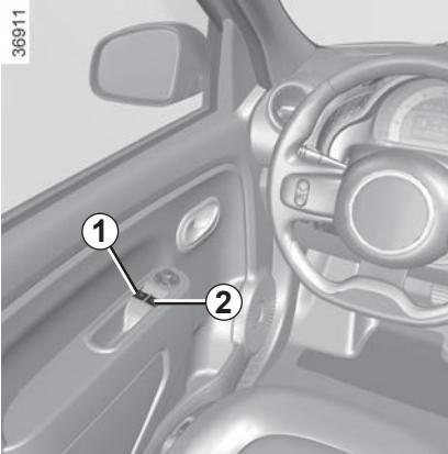
Pritisnite ili povucite prekidač stakla kako biste ga spustili ili podigli na željenu visinu.
