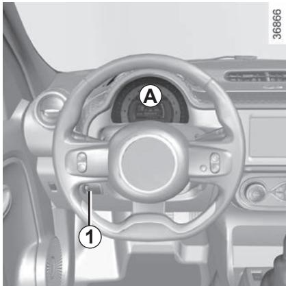
**Instrumentna ploča A:** osvjetjava se kod uključivanja kontakta.
