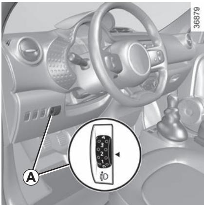
Komanda **A** upotrebljava se za podešavanje visine farova u skladu s opterećenjem.
