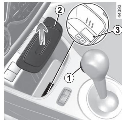
U slučaju da je ručica blokirana u stupnju P, čak i ako pritisnete papučicu kočnice i gumb za deblokiranje 1, postoji mogućnost da ručno oslobođite ručicu. Da biste to napravili, skinite tepih 2 na dnu pretinca za odlaganje za pristup ručici za otpuštanje 3. Zatim podignite ručicu 3 i istovremeno pritisnite gumb za otključavanje 1 na ručici.
