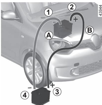
Ovisno o vozilu, otkvačite zaštitni crveni poklopac za pristup **priklučnom polu 2 (+)**.
