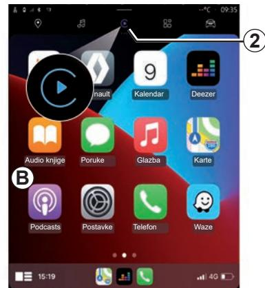
Usluga je pokrenuta na multimedijalnom sustavu i trebala bi biti vidljiva s područja **B**. Replikacija pametnog telefona zamjenjuje način rada “Telefon” i pojavljuje se ikona **2**.
