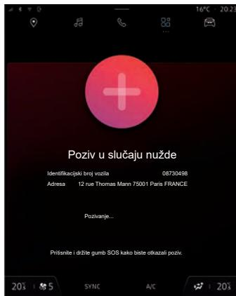
Upotreboom funkcije "Poziv u slučaju nužde" isključit će se neke naredbe i izbornici multi-medijskog sustava na oko sat vremena te će se time dati prednost telefonskim pozivima hitnim službama.
