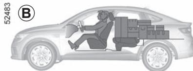
Predmete koji se prevoze treba ravnomjerno rasporediti po cijelom utovarnom prostoru.
