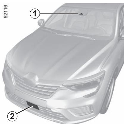
Sustav izračunava udaljenost od vozila koje se nalazi ispred te pješaka i biciklista koji se nalaze u blizini pomoću radara **2** i kamere **1**.
