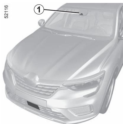
Sustav otkriva znakove ograničenja brzine uz rub ceste i prikazuje ograničenje brzine na instrumentnoj ploči.
