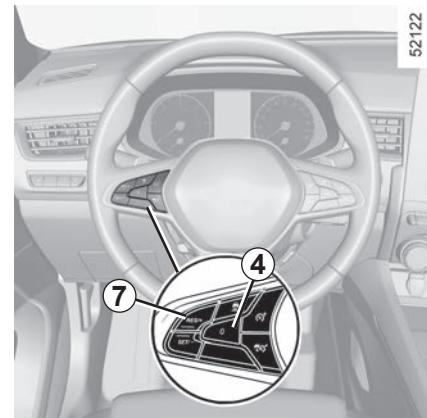
U svim slučajevima stanje mirovanja potvrđuje se prikazivanjem kontrolnih svjetala u sivoj boji i porukom "Adapt. tempomat odspojen" na instrumentnoj ploči.
