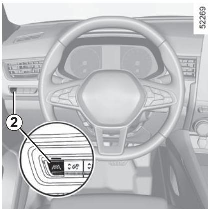
Za isključivanje funkcije pritisnite prekidač **2** onoliko puta koliko je potrebno kako biste na instrumentnoj ploči odabrali mogućnost "Pracanje trake iskljuceno".
