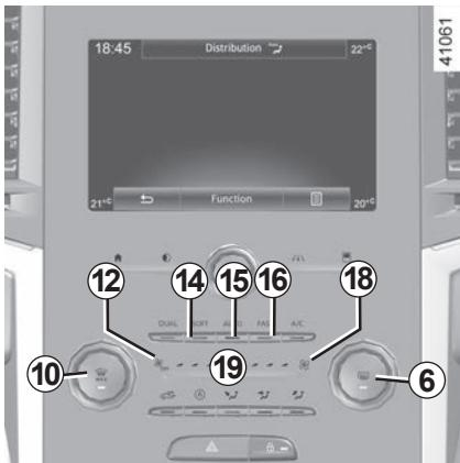
Pritisnite gumb **10**, pali se ugrađeno kontrolno svjetlo.
