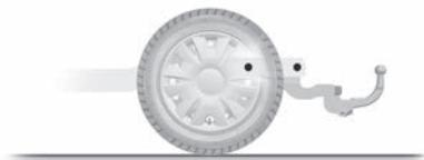
Uređaj za vuču ne smije ometati dijelove rasvjete ili registrarsku pločicu kada se ne koristi. Mehanički uređaji za vuču (kugla, kuka i sl.) koje je moguće ukloniti bez alata ili koji se mogu uvući moraju se skinuti ili premjestiti kada se ne koriste.
