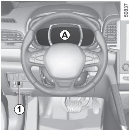
**Instrumentna ploča A:** osvjetljava se kada se otvore vrata vozača. Kada se upali kontakt, okrenite upravljač **1** da biste postavili svjetlinu instrumentne ploče.
