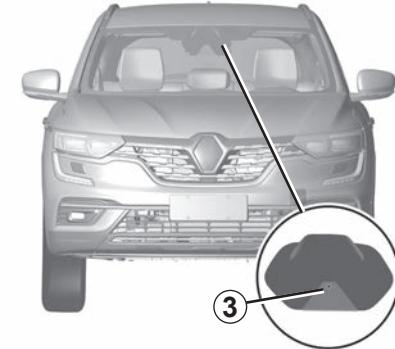
Sustav **B** upotrebljava senzor radara i kamere **3**.
