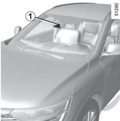
Upozorenje na prekomjernu brzinu s prepoznavanjem prometne signalizacije obavještava vozača na prelaženje ograničenja brzine na dijelu ceste na kojem se nalazi.
