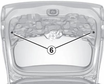
Okrenite nosač žarulje 6 u smjeru obrnutom od kazaljki na satu i zamijenite žarulju.
