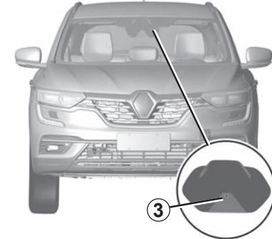
Sustav **B** upotrebljava senzor radara i kamere **3**.
