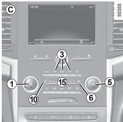
Pritisnite gumb **1**, pali se ugrađeno kontrolno svjetlo.
