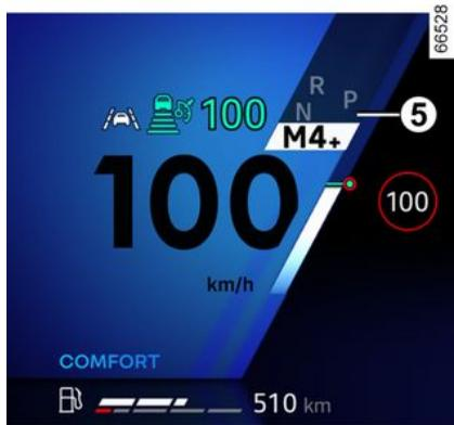
**Napomena** : ovisno o vozilu, povratak u automatski način rada vrši se dugim pritiskom na desnu ručicu ili pomicanjem impulsne ručice **1** za jedan ili dva stupnja prema dolje.
