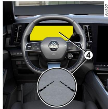
Kada je funkcija uključena,
