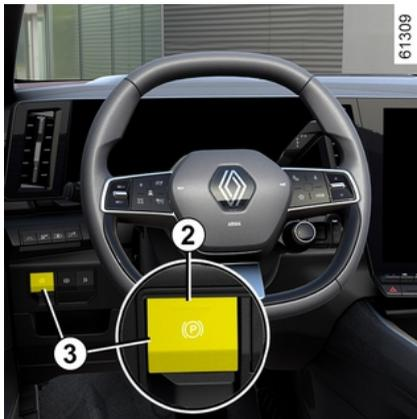
Da biste ručno aktivirali automatsku parkirnu kočnicu (pri zaustavljanju na crvenom svjetlu semafora ili u mirovanju dok motor radi itd.): povucite i otpustite prekidač **3**. Otpuštanje je automatsko s ponovnim pokretanjem vozila.
