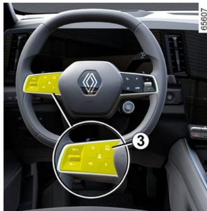
Funkcija prilagodljivog regulatora brzine Stop and Go isključuje se kada pritisnete prekidač **3**.
