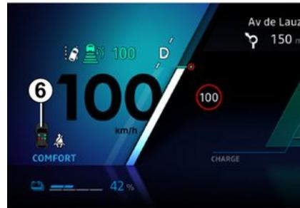
Kad su vrata zatvorena, sličica **6** prikazuje se na instrumentnoj ploči otprilike 60 sekundi nakon što se kontakt vozila uključi. Time se vozača obavještava o statusu pričvršćivanja svakog od prednjih sigurnosnih pojaseva:
