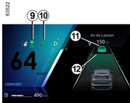
9. Kontrolno svjetlo upozorenja prilagodljivog regulatora brzine Stop and Go.
