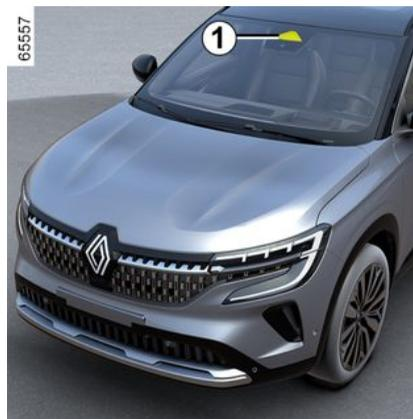
Na temelju informacija koje prenosi kamera 1 funkcija pokreće korektivnu radnju na sustavu upravljanja vozila u slučaju prelaska pune ili isprekidane crte ili pri približavanju rubu ceste (pregradi, prepreci, pločniku, nasipu itd.) bez uključivanja pokazivača smjera.
