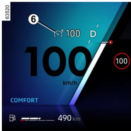
Rad funkcije ograničivača brzine prekida se kada pritisnete prekidač **1** za poništavanje odabira ograničivača. U ovom slučaju više nema upamćene brzine.
