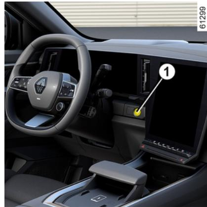
Pritisnite prekidač **1**, a da ne pritisćete pedale, kako biste uključili kontakt. Pritisnite papučicu kočnice, a zatim pritisnite prekidač **3**: isključuju se kontrolno svjetlo **2** na prekidaču i kontrolno svjetlo
