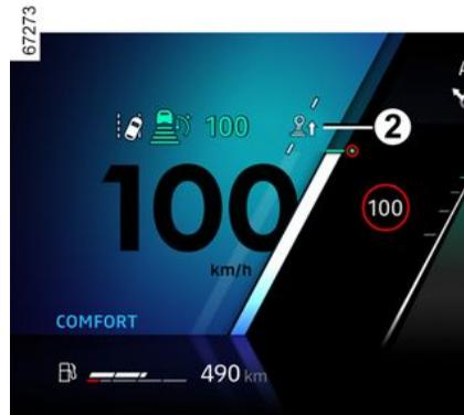
Ovisno o vozilu, a kako bi se optimizirala potrošnja goriva, kontrolno svjetlo na instrumentnoj ploči obavještava vas o tome koji je trenutak najprikladniji za uključivanje višeg ili nižeg stupnja prijenosa:
