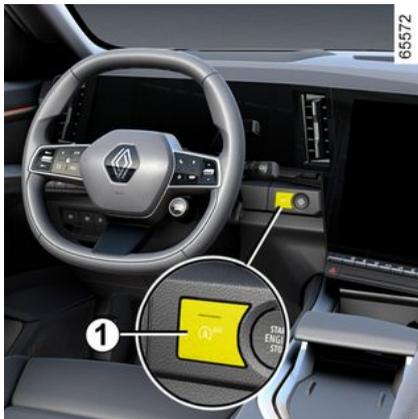
Za isključivanje funkcije pritisnite prekidač **1**. Na instrumentnoj ploči prikazuje se poruka "Sustav Start and Stop je isključen" i kontrolno svjetlo prekidača **1** počinje svijetliti.
