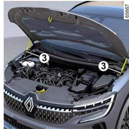
Podignite poklopac motornog prostora i usmjeravajte ga – poklopac motornog prostora drže dva podupirača **3**.
