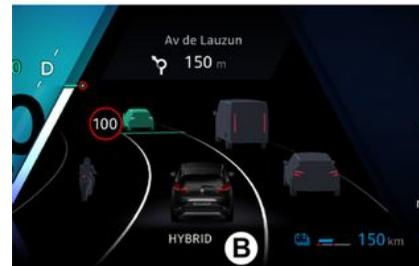
Prikaz **B** prikazuje bitne informacije na instrumentnoj ploči, zajedno s vašim vozilom i njegovom okolinom (trakama, okolnim vozilima koja se kreću u istom smjeru itd.).
