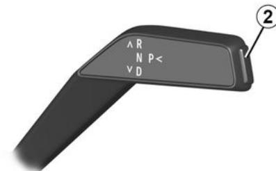
Uz zaustavljeno vozilo i uključen motor ili kontakt pritisnite gumb **2** da biste aktivirali položaj **P**.
