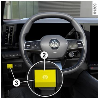
Povucite prekidač **3**. Uključuju se kontrolno svjetlo **2** i kontrolno svjetlo
