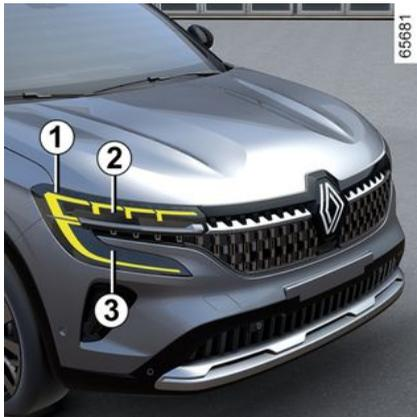
Vaše je vozilo opremljeno LED svjetlima. Kako biste ih zamijenili, obratite se ovlaštenom zastupniku.
