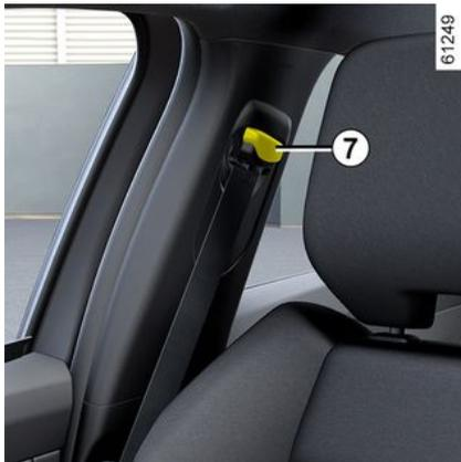
Pritisnite gumb **7** za podešavanje sigurnosnog pojaseva po visini tako da rameni pojas prelazi preko tijela na prethodno prikazan način. Pritisnite gumb **7** i podignite ili spustite sigurnosni po-
