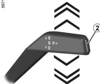
Ručicu mjenjača **1** pomaknite za jedan ili dva stupnja prema unaprijed ili unatrag da biste uključili željeni položaj (R, N ili D), a zatim otpustite ručicu te će se ona vratiti u stabilan položaj.
