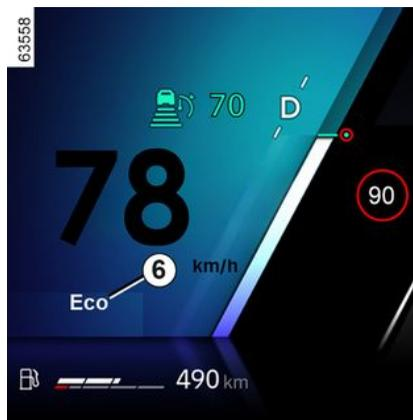
Za potvrdu uključivanja na instrumentnoj se ploči prikazuje kontrolno svjetlo "ECO" **6**.
