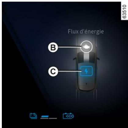
Na instrumentnoj se ploči prikazuje protok energije, ovisno o odabranom načinu vožnje.
