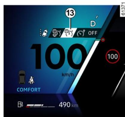
Pritisnite prekidač 3 za odabir prilagodljivog regulatora brzine 13. Kontrolno svjetlo 9 prikazuje se u svojoj boji. Na instrumentnoj ploči prikazuje se poruka "Adaptivni regul. brzine spreman: SET za aktivaciju" popraćena crticama, što ukazuje na uključenu funkciju regulatora brzine koja čeka na pohranjivanje putne brzine.
