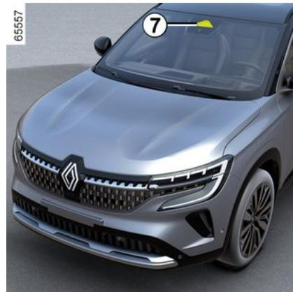
Ovisno o vozilu, prilagodljiva duga svjetla podijeljena su na nekoliko neovisnih okomitih segmenata. Ova funkcija upotrebljava kameru **7** koja se nalazi iza unutarnjeg retrovizora za otkrivanje vozila koja se nalaze ispred te vozila koja dolaze iz suprotnog smjera.
