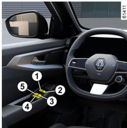
Nakratko pritisnite ili povucite prekidač prozora do kraja: staklo se podiže ili spušta do kraja. Djelovanjem na prekidač prekida se pomicanje stakla.
