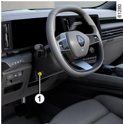
Spustite ručicu **1** i postavite kolo upravljača u željeni položaj.
