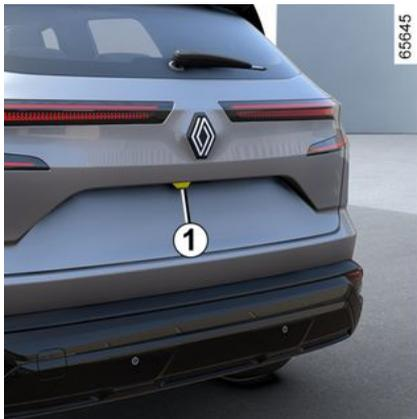
Prilikom vožnje unazad kamera **1** na vratima prtljažnika na multimedijски zaslon **2** prenosi sliku područja oko stražnjeg kraja vozila s od jednom do tri linije indikatora udaljenosti **3**, **4** i **5** (fiksni i pomičnim indikatorima udaljenosti te indikatorima udaljenosti prikolice).
