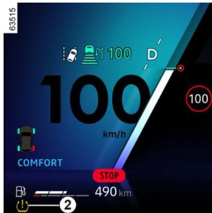
Ovaj sustav otkriva smanjenje tlaka u jednoj od guma mjerenjem brzine okretanja kotača u vožnji.
