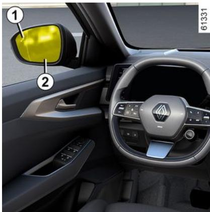
Kad se vrata otvore, ako se otkrije objekt koji se kreće, kontrolno svjetlo **1** prikazuje se na vanjskom retrovizoru **2** i, ovisno o vozilu, uključuju se unutar-nja svjetla na prednjim vratima.
