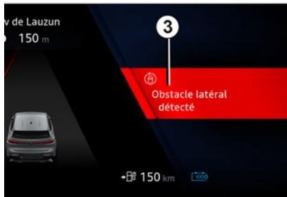
Ako je otkriveni objekt vrlo blizu, oglasit će se zvučni signal, zajedno s porukom upozorenja "Bočna prepreka otkrivena" **3** prikazanoj na instrumentnoj ploči.
