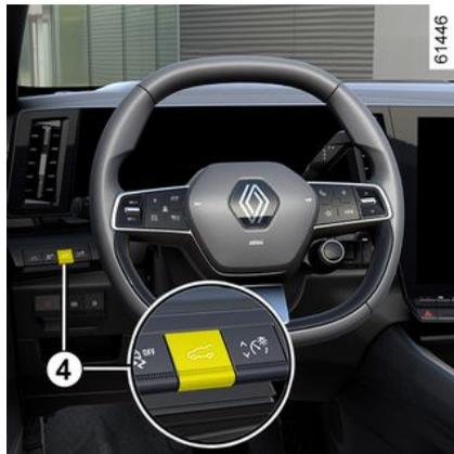
Da biste otvorili vrata prtljažnika, pritisnite i držite prekidač **4** dok ne začujete zvučni signal, a zatim otpustite prekidač.
