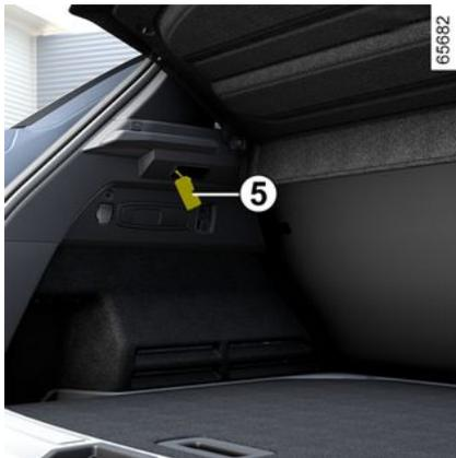
Otkvačite svjetlo prtljažnika **5** pritišćući jezičac s lijeve strane svjetla (s pomoću plosnatog odvijača ili sličnog alata). Izvadite žarulju koju želite promijeniti.
