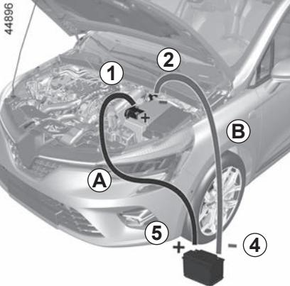
Pričvrstite pozitivni kabel **A** na **priklučni pol 1 (+)**, a zatim na **priklučni pol 5 (+)** akumulatora koji opskrbљuje strujom.
