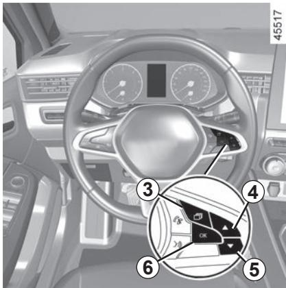
Za izlazak iz izbornika pritisnite **4** ili **5** za pri-stup "Nazad" i potvrđite pritiskom na **6** "OK". Možda će trebati ponoviti zahvat više puta.
