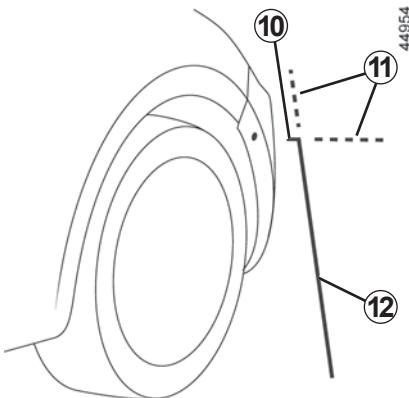
"Prednji bočni prikaz područja na suvozačevoj strani" prenosi se na multimedijski zaslon pomoću fiksnih linija navođenja za mjerjenje udaljenosti.
