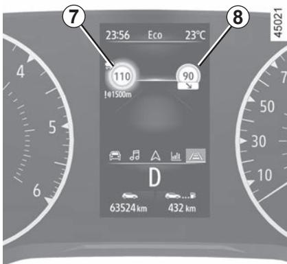
U slučaju prekoračenja ograničenja brzine, krug oko ploče treperi (kontrolno svjetlo 7) popraćen zvučnim signalom koji upozorava vozača.
