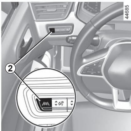
Da biste funkciju onemogućili, pritisnite prekidač **2** onoliko puta koliko je potrebno za odabir opcije "Pracenje trake iskljuceno" na instrumentnoj ploči.
