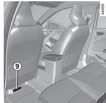
Otvori za usmjeravanje zagrijanog zraka prema prostoru za noge suvozača **9**.
