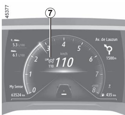
Kada je ograničivač u stanju mirovanja, pritiskom prekidača **3** ponovno se uključuje funkcija, a da se ne uzima u obzir upamćena brzina: brzina kojom vozilo vozi je ona koja se uzima u obzir.
