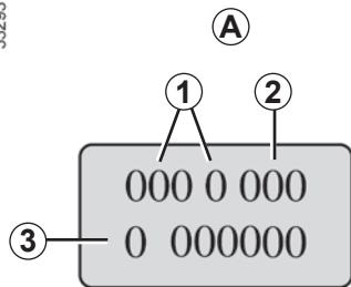
Podaci koji se nalaze na pločici motora u području A moraju biti navedeni u svim vašim pismima ili narudžbama.
