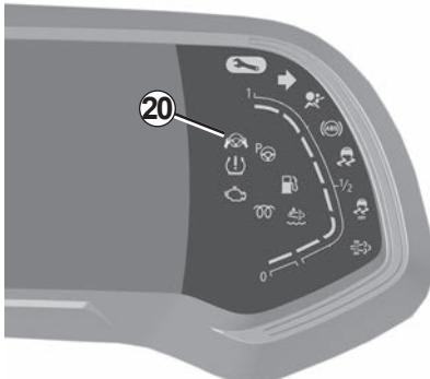
– **nakon otprilike 30 sekundi**, poruka "Drži ruke na volanu" pojavljuje se na instrumentnoj ploči 22, a kontrolno svjetlo
