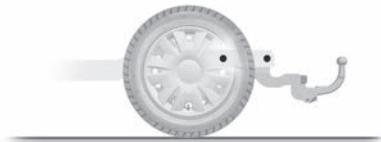
Uređaj za vuču ne smije ometati dijelove rasvjete ili registrarsku pločicu kada se ne koristi. Mehanički uređaji za vuču (kugla, kuka i sl.) koje je moguće ukloniti bez alata ili koji se mogu uvući moraju se skinuti ili premjestiti kada se ne koriste.
