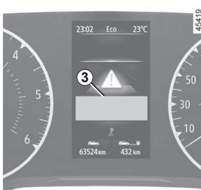
Ako je uključeno kočenje u nuždi prouzročilo zaustavljanje vozila, vozilo se kratko zadržava u zaustavljenom položaju. Nakon tog vremenskog ograničenja, vozač mora držati vozilo u zaustavljenom položaju držeći nogu na papučici kočnice.
