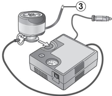
Kada je guma pravilno napuhana, uklonite komplet: polako odvijte nastavak za napuhavanje spremnika 3 da biste sprječili prolijevanje sredstva i pohranite spremnik u plastično pakiranje da biste sprječili curenje proizvoda.
