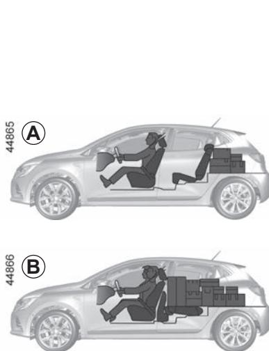
Predmete koji se prevoze treba ravnomjerno raspoređiti po cijelom utovarnom prostoru.
