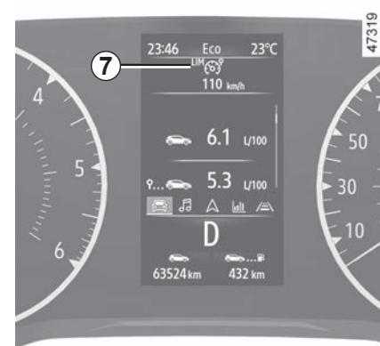
Za pohranjivanje trenutne brzine pritisnite prekidač 4 (RES+) ili prekidač 3 (SET-): ograničenje brzine zamjenjuje crtice i, ovisno o vozilu, kontrolno svjetlo 7 prikazuje se u bijeloj boji.
