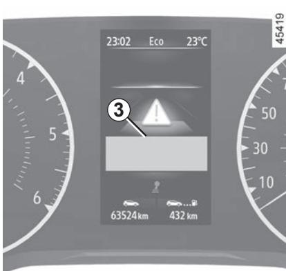
Ako je uključeno kočenje u nuždi prouzročilo zaustavljanje vozila, vozilo se kratko država u zaustavljenom položaju. Nakon tog vremenskog ograničenja, vozač mora držati vozilo u zaustavljenom položaju držeći nogu na papučici kočnice.
