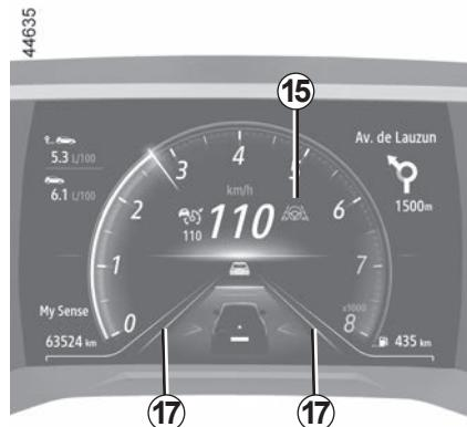
Nakon ispunjavanja svih uvjeta, funkcija ponovno usmjerava vozilo u sredinu prometne trake. Kontrolno svjetlo **15**
