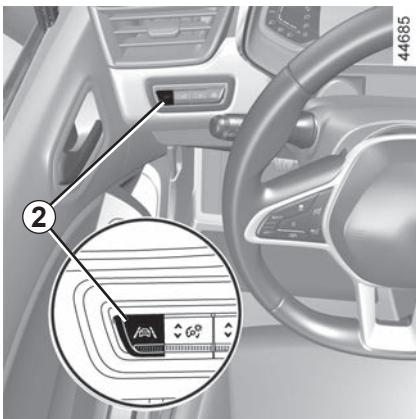
Da biste funkciju onemogućili, pritisnite prekidač **2** onoliko puta koliko je potrebno za odabir opcije "Upozorenje trake isključeno" (ili, ovisno o vozilu, opcije "Pracenje trake isključeno") na instrumentnoj ploči. Kontrolno svjetlo na instrumentnoj ploči se gasi.
