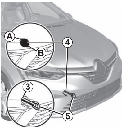
Upotrebljavajte isključivo prednje 3 i stražnje vučne točke 7 (nikada poluosovine ili neki drugi dio vozila). Vučne točke mogu se upotrebljavati samo za vuču. Ni u kojem slučaju one ne smiju služiti za izravno ili neizravno podizanje vozila.
