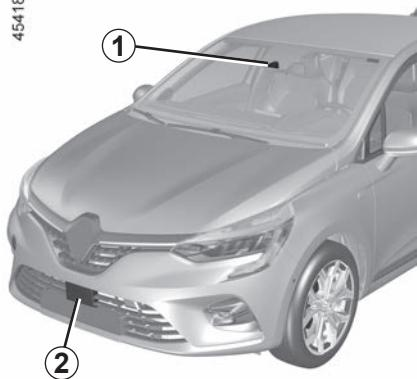
Sustav upotrebljava podatke s radara **2** i kamere **1**, radi određivanja udaljenosti od vašeg vozila:
