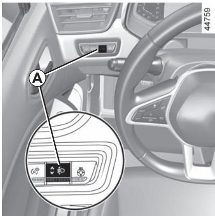
Prekidač **A** omogućuje podešavanje visine svjetla farova u skladu s opterećenjem.
