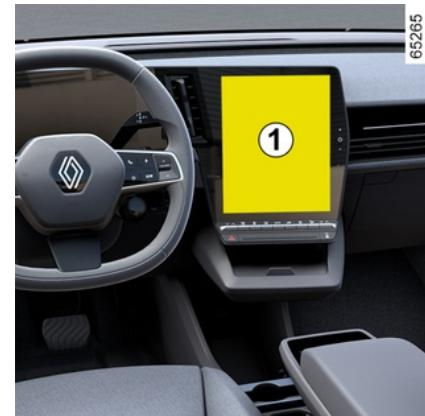
Dok vozilo miruje i motor je uključen, u svjetu "Vozilo" **2** na multimedijskom zaslonu **1** pritisnite izbornik "Električno", **3** a zatim karticu "Punjjenje i klimatizacija" da biste pristupili postavkama.
