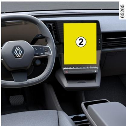
Kada uključite stupanj prijenosa za vožnju unazad, na multimedijalnom zaslonu 2 pritisnite gumb "Postavke" kako biste dodali ili uklonili linije indikatora udaljenosti i prilagodili postavke slike kamere (svjetlina, kontrast itd.).
