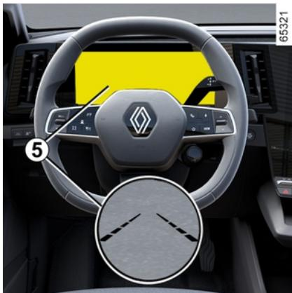
Kada je funkcija uključena, kontrolno svjetlo te pokazivači lijeve i desne crte **5** prikazuju se u sivoj boji na instrumentnoj ploči.
