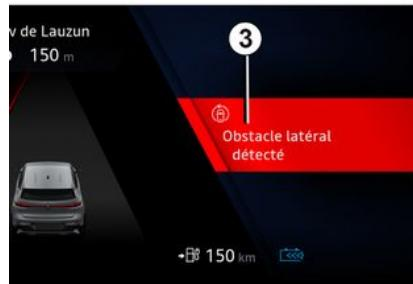
Ako je otkriveni objekt vrlo blizu, ogla-sit će se zvučni signal, zajedno s poru-kom upozorenja "Bočna prepreka otkri-vena" **3** prikazanoj na instrumen-tnoj ploči.
