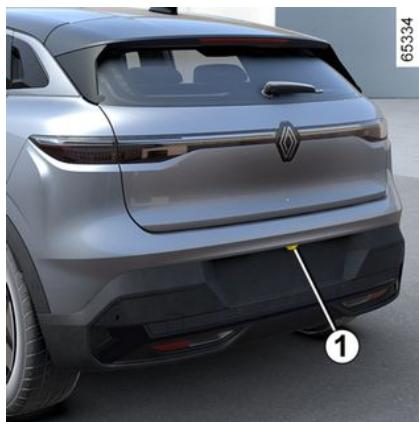
Kada je uključen stupanj prijenosa za vožnju unazad, kamera 1 koja se nalazi na stražnjoj strani vozila prenosi prikaz područja iza vozila na multimedijalni zaslon 2 s tri linije indikatora udaljenosti 3, 4 ili 5 (fiksne, pomične i za prikolicu).
