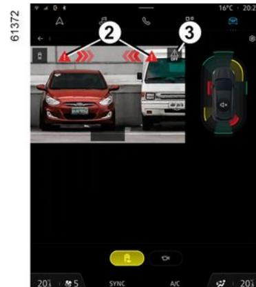
Ako sustav prepozna da je vaše vozilo opremljeno kukom za vuču i priključena je prikolica, aktivno naglo kočenje u stupnju za vožnju unazad automatski se isključuje i na instrumentnoj ploči prikazuje se poruka: "Prikolica: parking
