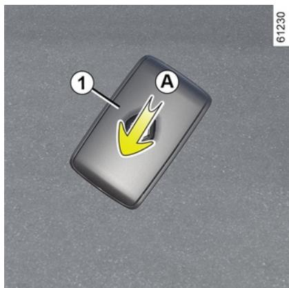
Kada se na instrumentnoj ploči prikaže poruka "Baterija kartice slaba", zamijenite bateriju kartice:
