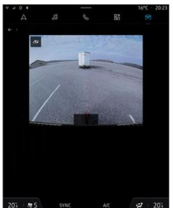
Ako je prikolica povezana, u stupnju prijenosa za vožnju unaprijed, pritisnite izbornik "Kamera s prikazom od 360°" u načinu rada "Vozilo" na multimedijalnom zaslonu **5** kako biste kameri **3** omogućili prijenos prikaza prostora oko vozila tijekom otprilike 30 sekundi.
