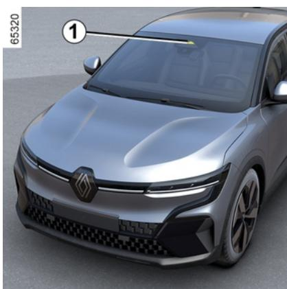
Sustav prikazuje ograničenja brzine na instrumentnoj ploči prema prometnim znakovima otkrivenim uz rub ceste.
