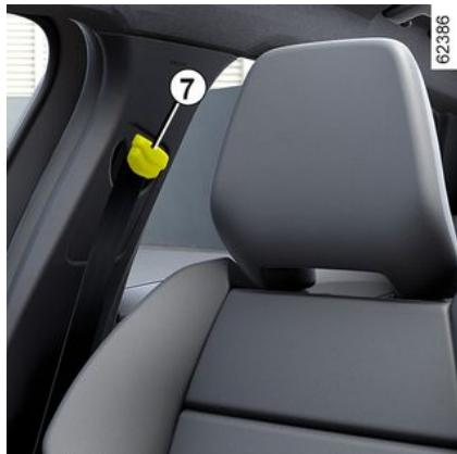
Pritisnite gumb **7** za podešavanje sigurnosnog pojasa po visini tako da rameni pojas prelazi preko tijela na pretvodno prikazan način. Pritisnite gumb **7** i podignite ili spustite sigurnosni pojas. Kada ste sve podesili, provjerite da li je zabravljenje pojasa dobro.
