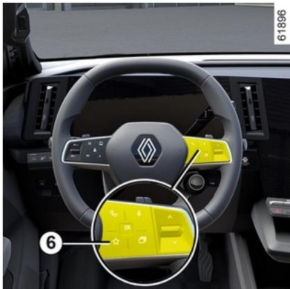
Ovisno o vozilu, pritiskom komande na kolu upravljača **6** možete aktivirati grijanje kola upravljača u skladu s pretvodno definiranim postavkama upotrebe koje ste pohranili.
