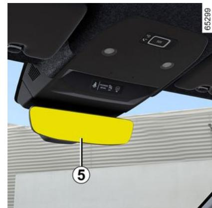
Retrovizor se automatski zatamnjuje kada je iza vas vozilo s upaljenim dugim svjetlima ili u slučaju nekog drugog jakog osvjetljenja.
