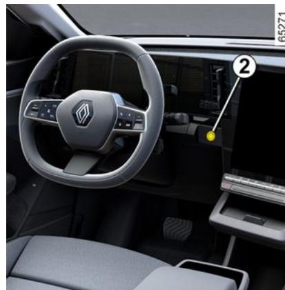
Ako pametni telefon više nije u putničkom prostoru kada želite isključiti motor, na instrumentnoj ploči prikazuje se poruka: pritisnite i držite gumb za pokretanje/zaustavljanje motora 2 dulje od dvije sekunde.
