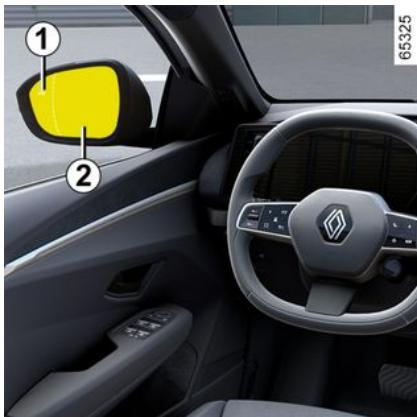
Kad se vrata otvore, ako se otkrije objekt koji se kreće, kontrolno svjetlo **1** prikazuje se na vanjskom retrovizoru **2** i, ovisno o vozilu, uključuju se unutar-jna svjetla na prednjim vratima.
