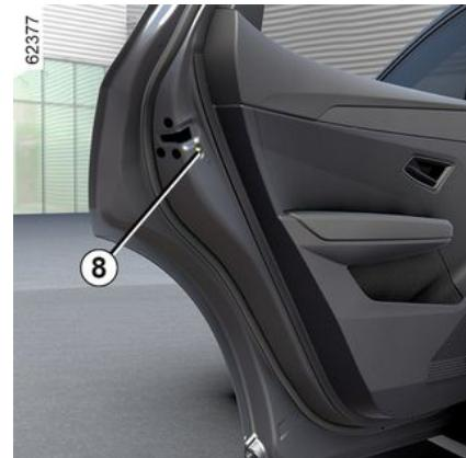
Da se stražnja vrata ne bi mogla otvoriti iznutra, spustite ručicu **8** i iznutra potvrdite da su vrata zaključana.
