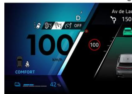
10. Kontrolno svjetlo upozorenja prilagodljivog regulatora brzine Stop and Go.
