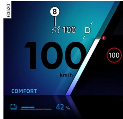
Kontrolno svjetlo 8 prikazuje se u sivoj boji. Poruka "Ograničivač brzine spreman: POSTAVI na uključeno" prikazuje se na instrumentnoj ploči popraćena crticama, kako bi se označilo da je funkcija ograničivača brzine uključena i da čeka na pohranjivanje brzine ograničenja.
