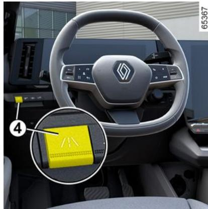
Prije uključivanja funkcije, u svjetu "Vozilo" na multimedijском zaslonu 2 pritisnite izbornik "Pomoć pri vožnji", a zatim izbornik "Sustav zadržavanja trake" i odaberite "Upozorenje na napuštanje trake".
