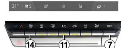
Komanda **11** odobrava uključivanje (uključeno kontrolno svjetlo) ili isključivanje (isključeno kontrolno svjetlo) klima uređaja.
