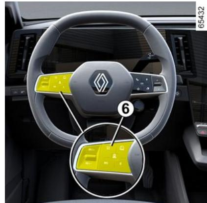
Za prilagodbu ograničivača brzine, regulatora brzine ili zadane vrijednosti prilagodljivog regulatora brzine otkrivenom ograničenju brzine, pritisnite prekidač 6.
