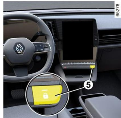
Prekidač **5** istovremeno kontrolira vrata vozila i vrata prtljažnika.
