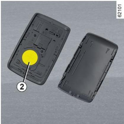
Za vraćanje postupite obrnutim redoslijedom, a zatim četiri puta pritisnite jedan od gumba na kartici dok se nalazi te u blizini vozila: sljedeći put kad se vozilo pokrene, poruka će nestati.
