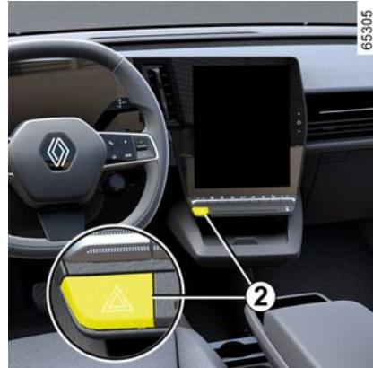
**⚠️** Pritisnite prekidač **2**. Ovaj mehanizam uključuje istovremeno sva četiri žmigavca i bočne pokazivače smjera.
