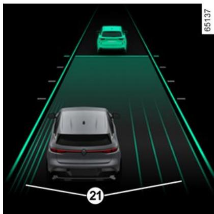
Da biste uključili položaj u traci, funkcija "Centriranje vozila u prometnoj traci" mora biti u načinu rada za podešavanje, zeleno kontrolno svjetlo **22** mora biti prikazano na instrumentnoj ploči, a brzina vozila mora biti ispod 50 km/h.
