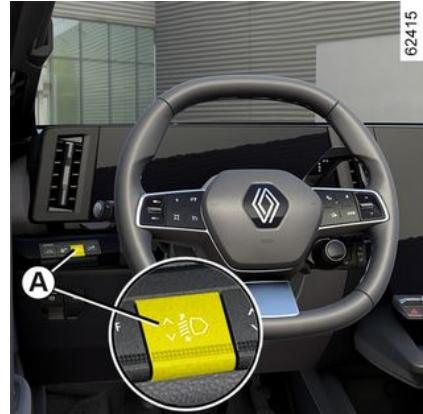
Ovisno o vozilu, prekidač **A** može se upotrebljavati za prilagodbu visine farova u skladu s opterećenjem.
