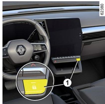
Prilikom pokretanja vozila, sustav automatski zaključa sve otvarajuće dijelove kada dosegnete brzinu od oko 10 km/h.
