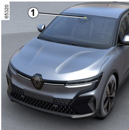
Na temelju informacija koje prenosi kamera **1** funkcija pokreće korektivnu radnju na sustavu upravljanja vozila u slučaju prelaska pune ili isprekidane crte ili pri približavanju rubu ceste (pregradi, prepreci, pločniku, nasipu itd.) bez ukључivanja pokazivača smjera.
