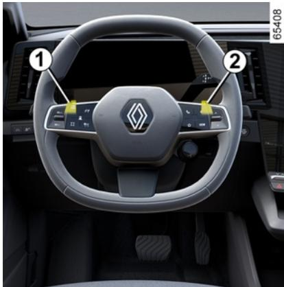
Ovisno o vozilu, ručice 1 i 2 mogu se upotrebljavati za promjenu razine regenerativnog kočenja kada se ručica stupnja prijenosa nalazi u položaju D.
