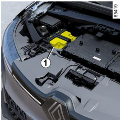
Pomoći akumulator je akumulator od 12 V: daje energiju potrebnu za rad opreme vozila (svjetla, brisači vjetrobranskog stakla, podizanje stakala, audiosustav itd.) te određenih sigurnosnih sustava kao što je, primjerice, pomoći pri kočenju.
