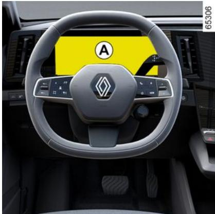
**Instrumentna ploča A:** ovo se upali kad se otvore vrata vozača. Da biste prilagodili svjetlinu instrument ploče, pogledajte upute za multimediju.
