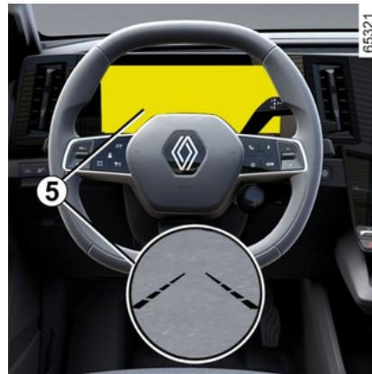
Kada je funkcija uključena, ili te pokazivači lijeve i desne crte 5 prikazuju se u sivoj boji na instrumentnoj ploči.
