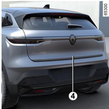
Dok se kartica nalazi u području **1** i vozilo je zaključano, jednom pritisnite gumb **4** da biste otključali cijelo vozilo.
