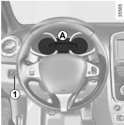
**Instrumentna ploča A:** Osvjetljava se kod uključenja kontakta. Možete podesiti jačinu osvjetljavanja okretanjem kotačića **1**. Paljenje nekih kontrolnih svjetala popraćeno je porukom.
