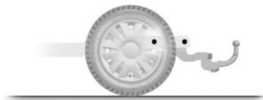
Ako kuka za vuču sakriva registracijsku pločicu ili stražnje svjetlo za maglu, trebate je skinuti kada ne vučete teret.
