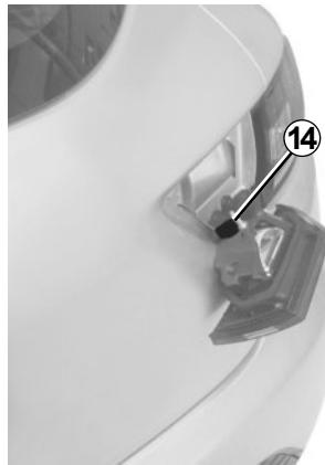
Okrenite nosač žarulje 14 u smjeru obrnutom od kazaljki na satu i zamjenite žarulju.
