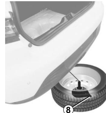
Nakon zamjene kotača stavite skinuti kotač na nosač 7, ventil okrenut prema tlu. Zakvačite sajlu 5 u ležište 6, a zatim gurnite kotač ispod prtljažnika.
