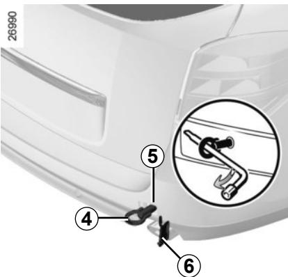
Upotrebljavajte isključivo prednja **3** i stražnja **5** priključna mesta (nikada cijevi poluosovina ili neki drugi dio vozila). Ta priključna mesta mogu se upotrebljavati samo za vuču i ni u kojem slučaju ne mogu služiti za podizanje vozila.
