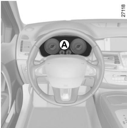
**Instrumentna ploča A:** osvjetljava se kod uključivanja kontakta.
