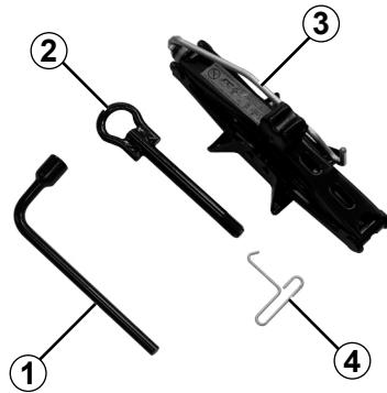
Komplet alata nalazi se u prtljažniku: podignite podnu oblogu prtljažnog prostora, a zatim odvijte središnje pričvršćenje.
