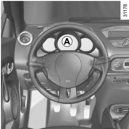
**Instrumentna ploča A:** možete podešiti jačinu svjetlosti na putnom računalu.
