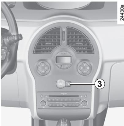
Zaključavanje vozila s jednim otvaraјucim dijelom otvorenim (prijevoz predmeta u otvorenom prtljažniku...) ili kada se nalazi u području jakog elektro-magnetskog zračenja ili u slučaju neispravnosti ključa: kada je motor zaustavljen, pritisnite i držite pritisnut duže od pet sekundi gumb **3**.
