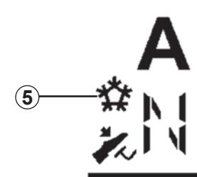
Položaj način rada za snijeg se uključuje automatski. Ako uključite ručni način rada, njegov će rad biti isključen.
