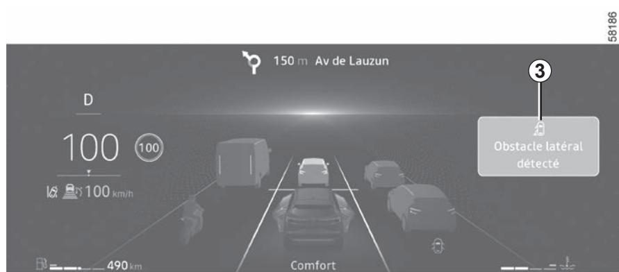
Ako je otkriveni objekt vrlo blizu, oglasit će se zvučni signal, zajedno s porukom upozorenja **3** "Bočna prepreka otkrivena" prikazanoj na instrumentnoj ploči.
