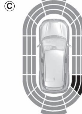
Ovisno o udaljenosti prepreke, povećava se učestalost zvučnih signala sve dok ne postane stalni signal na udaljenosti od 20 cm za prepreke sa strane i 30 cm za prepreke ispred ili iza vozila. Na zaslonu **C** prikazat će se zeleno, narančasto (ili žuto, ovisno o vozilu) i crveno područje.
