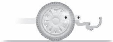
Uređaj za vuču ne smije ometati dijelove rasvjete ili registrsku pločicu kada se ne koristi. Mehanički uređaji za vuču (kugla, kuka i sl.) koje je moguće ukloniti bez alata ili koji se mogu uvući moraju se skinuti ili premjestiti kada se ne koriste.
