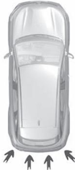
Osim funkcije "Pomoć pri parkiranju" → 2.144 i pomoću podataka iz četiri središnja senzora na stražnjem dijelu vozila, sustav otkriva fiksne prepreke koje se nalaze iza vašeg vozila. Ako postoji značajna opasnost od sudara, sustav automatski pokreće kočenje vozila.
