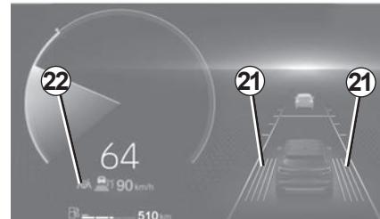
Nakon ispunjavanja svih uvjeta, funkcija ponovno usmjerava vozilo u sredinu prometne trake. Kontrolno svjetlo **22**
