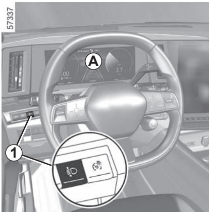
**Instrumentna ploča A:** osvjetljava se kad se otvore vrata vozača. Pritisnite prekidač **1** onoliko puta koliko je potrebno da prilagodite svjetlinu.
