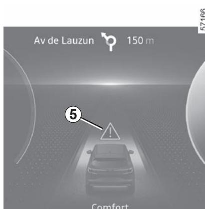
Ako je uključeno kočenje u nuždi prouzročilo zaustavljanje vozila, vozilo se kratko država u zaustavljenom položaju. Nakon tog vremenskog ograničenja, vozač mora držati vozilo u zaustavljenom položaju držeći nogu na papučici kočnice.
