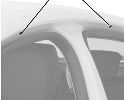
Otvorite vrata, za pristup umecima za pričvršćenje 1.
