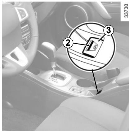
Zatezanje automatske parkirne kočnice potvrđeno je porukom "Parking brake on" i kontrolnim svjetлом
