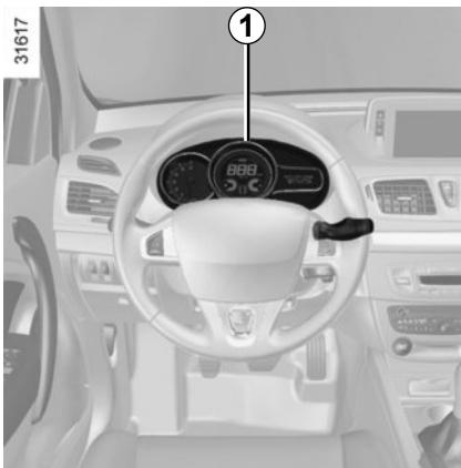
Ako je vozilo njom opremljeno, ova funkcija, ugrađena u putno računalo 1, omogućava uključivanje/isključivanje i podešavanje određenih funkcija vozila.
