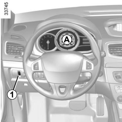
Prilikom uključenja kontakta uključuje se instrumentna ploča. Okrenite kotačić **1** za podešavanje jačine osvjetljenja instrumente ploče. U određenim slučajevima kontrolna svjetla se uključuju uz poruku.
