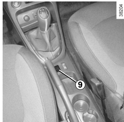
**Vozila opremljena ECO načinom rada (prekidač 9):** kada je pokrenut, ECO način rada može smanjiti radne karakteristike klima uređaja s automatskim upravljanjem. Pogledajte članak "Eko vožnja" u 2. poglaviju.
